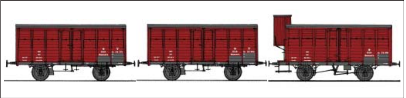
3-Wagen set mit DSB QD 23772 (mit Handbremse), QD 23803 (mit Handbremse) und QF 23858 (mit Bremserhaus)
